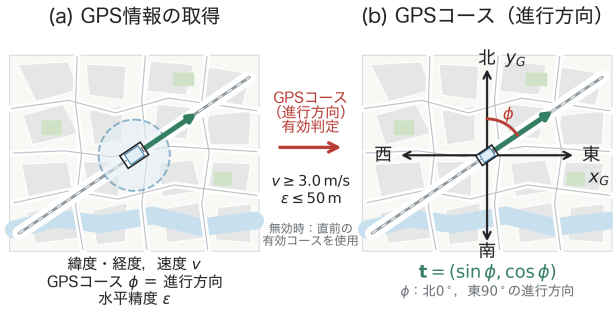
図 2 GPS 情報の取得と GPS コース（進行方向）から移動方向ベクトルへの変換
