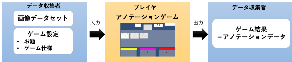
図 1 本提案でのデータの流れ. データ収集者は、画像データセットとゲーム設定をアノテーションゲームに入力する. プレイヤーはアノテーションゲームを行う. プレイヤーが行なったアノテーションゲームの結果をデータ収集者は受け取る.
