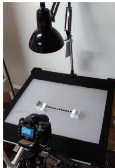
図 5 赤外光の波長と IR フィルタの組合せの検証実験の様子 Fig. 5 Experimental setting for inspecting combination of infrared wavelengths and IR filters.
