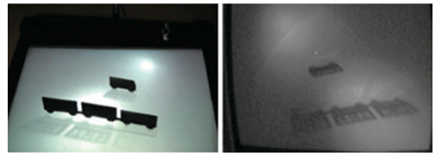
図 4 提案システムで生成される影 (左:スクリーン上部から見た影, 右:スクリーン下部からカメラで撮影した影)
