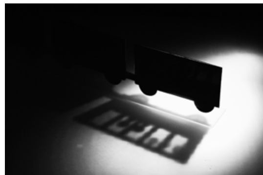
図 9 Layered Shadow アプリケーションによって生成された影 (左：940 nm の赤外ライト照射時、右：810 nm の赤外ライト照射時)
