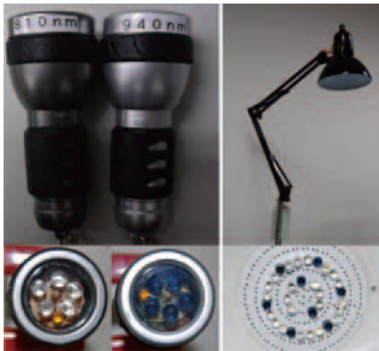
図 3 赤外ライト (左:ハンドヘルドライト, 右:アームライト) Fig. 3 Infrared light sources (Left: handheld light, Right: arm light).
